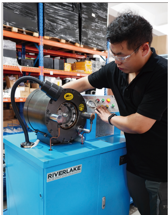
液压软管制作
